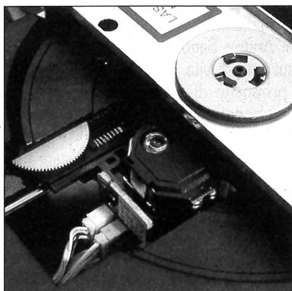
**Il movimento del pick up laser è di tipo tangenziale. Si intravedono le guide di scorrimento in acciaio del carrellino.**
